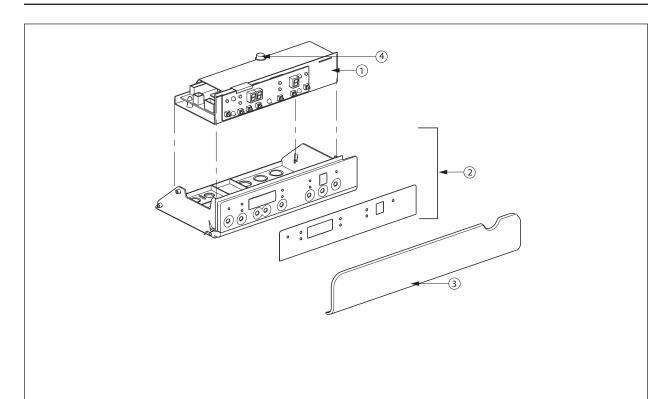
Fig. 33: CHALLENGER Control Components
